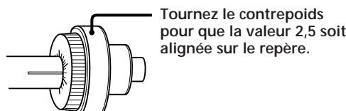
Si vous utilisez une cartouche disponible en option Tournez le contrepoids dans le sens inverse des aiguilles d'une montre pour aligner la bague graduée sur la force d'appui correcte. La bague de réglage de la force d'appui est graduée par intervalles de 0,1 g, et un tour complet du contrepoids représente une force d'appui de 3 g.
