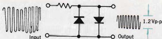
Fig. 1-1 Diode limiter
