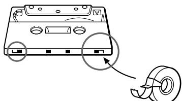
Quand vous utilisez une cassette de type II ou IV, veillez à ne pas recouvrir les fentes de détection servant à déterminer le type de cassette.
