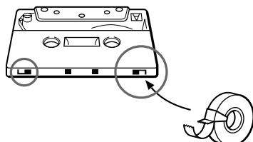
Quando estiver a utilizar uma cassete do tipo II ou IV, seja cuidadosos para não cobrir as aberturas de detecção a serem utilizadas pelo deck para determinar o tipo de cassete.
