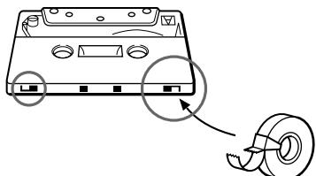
Cuando utilice cassettes de tipo II o IV tenga cuidado de no cubrir las ranuras detectoras que utiliza el deck para determinar el tipo de cinta.
