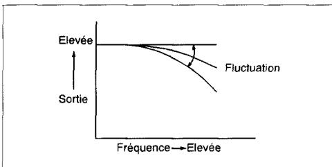
Avec le système Dolby HX PRO, le montant de polarisation effectif est contrôlé en millisecondes et réduit considérablement les distorsions, améliorant ainsi la linéarité de la réponse des hautes fréquences et assure un enregistrement présentant un minimum de distorsions et de parasites.
