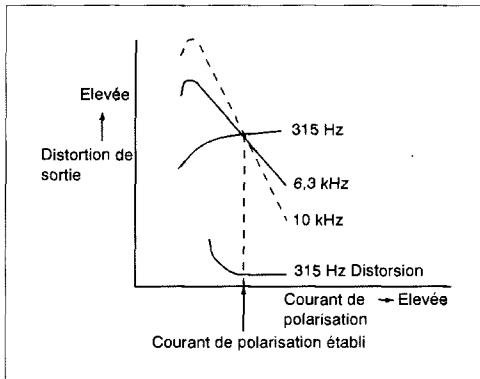
Comme on peut l'observer sur l'illustration, le niveau de sortie et la distorsion diffèrent considérablement, suivant le courant de polarisation (haute fréquence). Dans les systèmes ordinaires, le courant de polarisation subit des variations dans certains signaux d'enregistrement (voir schéma suivant), ce qui provoque des fluctuations dans la réponse en fréquence, une distorsion ou autres caractéristiques indésirables.
