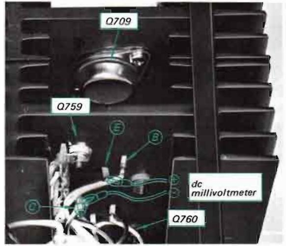
Fig. 3-14. Dc millivoltmeter connection
