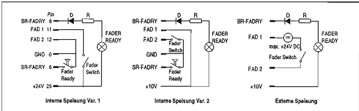
Fig. 1.13 FADER START-Funktion mit interner oder externer Spelung am Anschluss PAR. REM. CTRL
