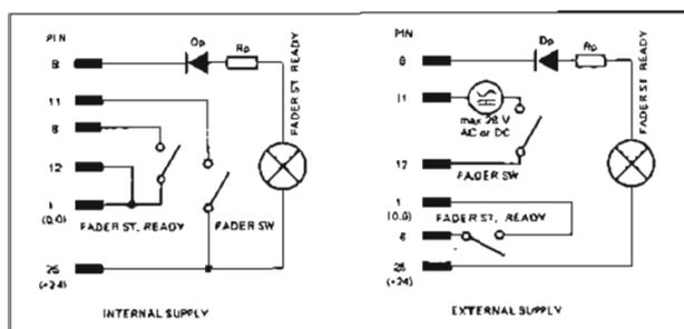
Fig. 2.4.7 FADER START CIRCUIT
