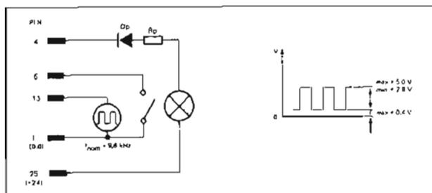
Fig. 2.4.6 VARISPEED CONTROL CIRCUIT
