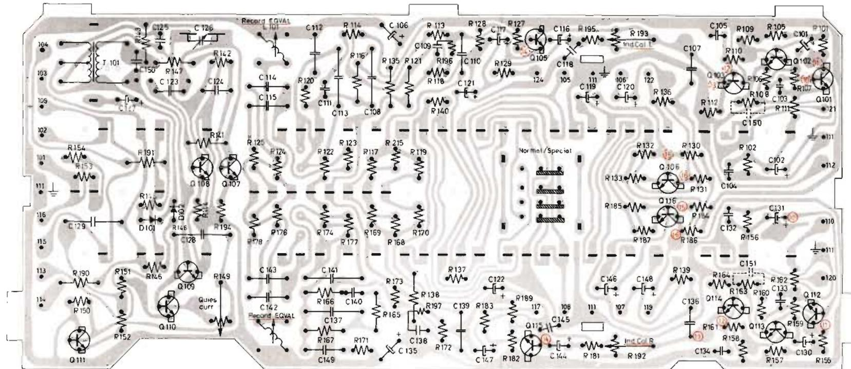
Plate for korreksjonsforere, forforere, indikatorforere og oscillator, sett fra foliesiden
