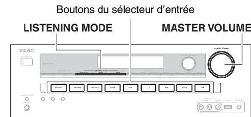
**1** Utilisez les boutons du sélecteur d'entrée pour sélectionner la source d'entrée.
