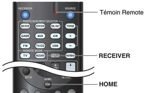
Pour réinitialiser la télécommande à ses valeurs par défaut, tout en maintenant enfoncé le bouton **RECEIVER**, maintenez enfoncé le bouton **HOME** jusqu'à ce que le témoin Remote s'allume (au bout d'environ 3 secondes). Appuyez de nouveau sur **RECEIVER** dans les 30 secondes.
