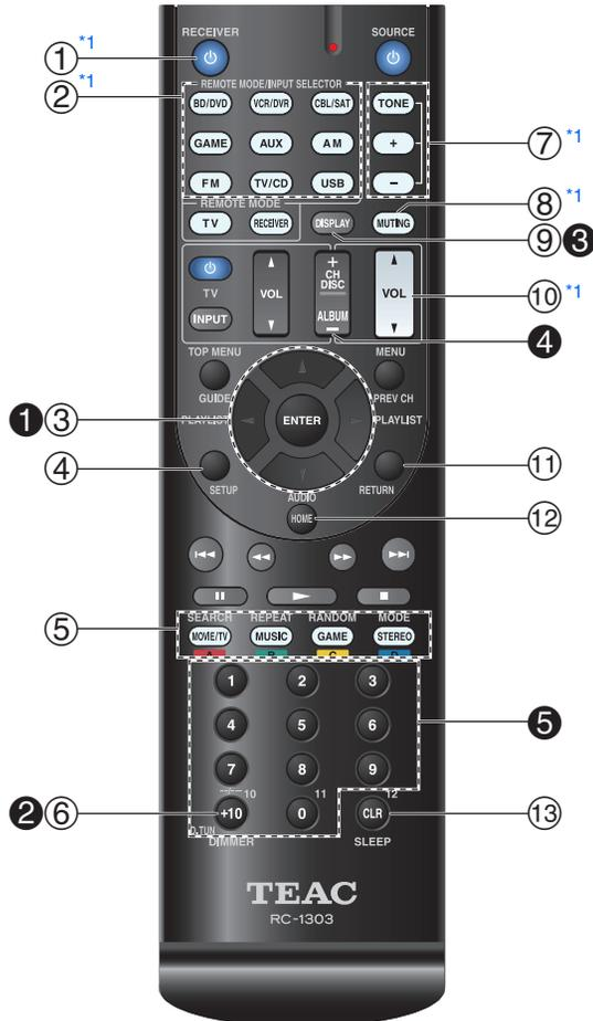
Pour utiliser l'ampli-tuner AV, appuyez sur **RECEIVER** pour sélectionner le mode Récepteur. Vous pouvez également utiliser la télécommande pour contrôler votre lecteur disque Blu-ray/DVD, votre lecteur CD TEAC (Esoteric)/TASCAM et d'autres appareils. Consultez « Saisie des codes de télécommande préprogrammés » pour toute information complémentaire (→ [page 54](#)).
