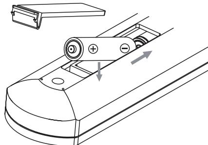
**1** Öffnen Sie die Batteriefachabdeckung der Fernbedienung.
