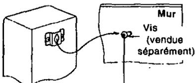
Insérer une vis à bois dans une section épaisse et résistante du mur.
