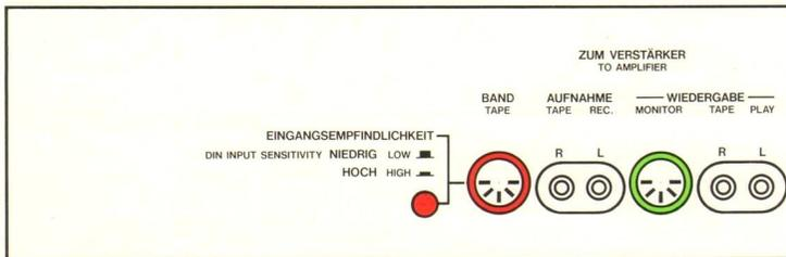
Anschluß eines Verstärkers oder Receivers **mit** Monitorbuchse
