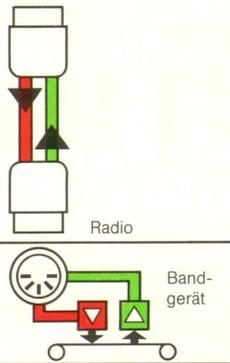
Anschluß eines Tonbandgerätes oder Cassettenrecorders mit **2 Tonköpfen**
