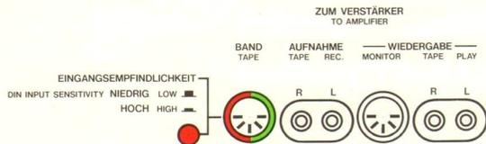
Anschluß eines Verstärkers oder Receivers **ohne** Monitorbuchse
