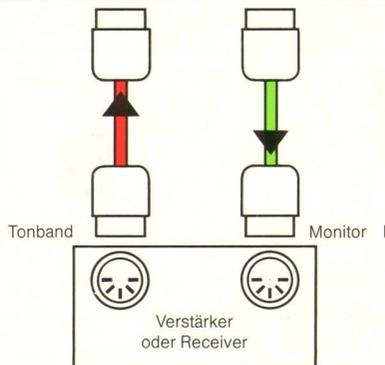
Es gibt Tonbandgeräte und Cassettensrecorder, die zwar eine Monitor-Buchse haben, aber trotzdem nur über einen kombinierten Aufnahme/Wiedergabe-Kopf verfügen. Bei diesen Geräten führt die Monitor-Buchse bei Aufnahme das aufzunehmende Tonsignal, bei Wiedergabe jedoch die vom Band kommende Modulation. Solche Geräte können nach Abb. D angeschlossen werden. Hier hören Sie bei Anschluß des Verstärkers nach Abb. C sowohl bei Monitor- als auch bei Normalbetrieb die gleiche Toninformation.
